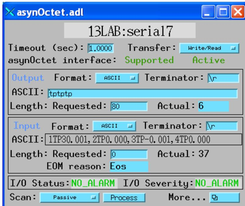
Configure serial port parameters
